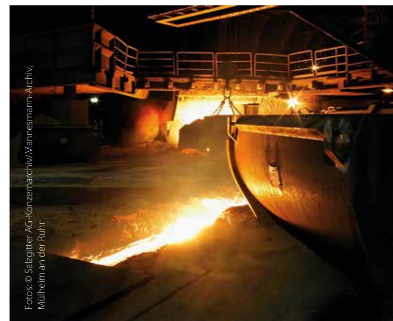
Abstich bei HKM: Der glühende Stahl „fließt“ durch die Anlage
